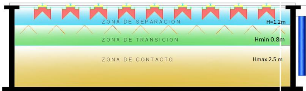
Ilustración 26: Zonas del reactor UASB
